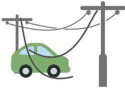
Si un cable del tendido eléctrico cae sobre su auto mientras está manejando, quédese dentro del vehículo y siga manejando para alejarse del cable. Si el motor se para, no apague su auto. Llame o pídale a alguien que llame a la compañía eléctrica local y a los servicios de emergencia. No permita que nadie se acerque al vehículo a menos que sea alguien del personal de emergencia.
