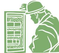
Si los circuitos y los equipos eléctricos se mojaron o se cayeron dentro o cerca del agua, desconecte la corriente eléctrica desde el interruptor principal o el fusible del panel de servicio. No se meta en agua estancada para lograr acceso al interruptor principal. Llame a un electricista para que lo desconecte.
