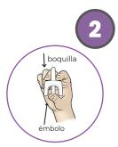
Sostenga el dispositivo con el pulgar en el émbolo y con el dedo índice y el dedo corazón a cada lado de la boquilla.
